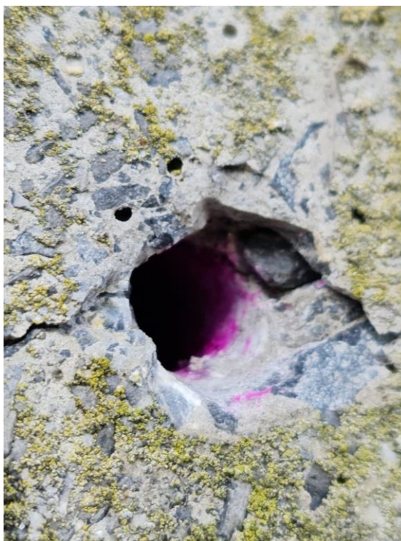
Obr. 61 Fenolftaleínová skúška na nosníku
