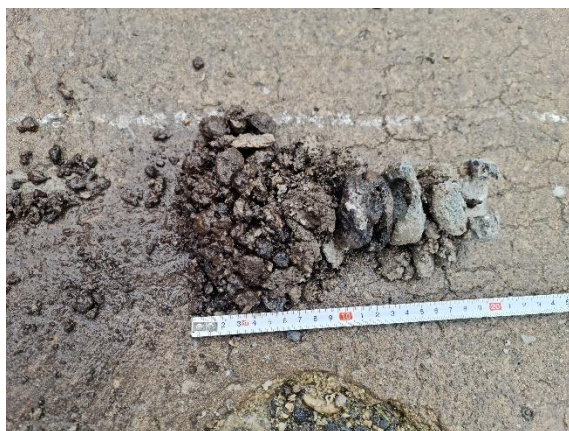
Obr. 56 Meranie zloženia vozovky z vývrtu
