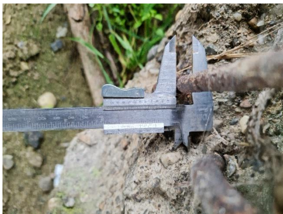
Obr. 77 Meranie priemeru výstuže
