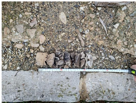
Obr. 55 Meranie zloženia vozovky z vývrtu
