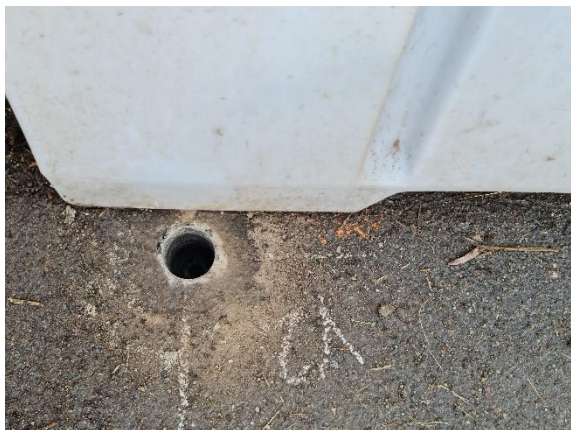
Obr. 54 Vývrt na vozovke
